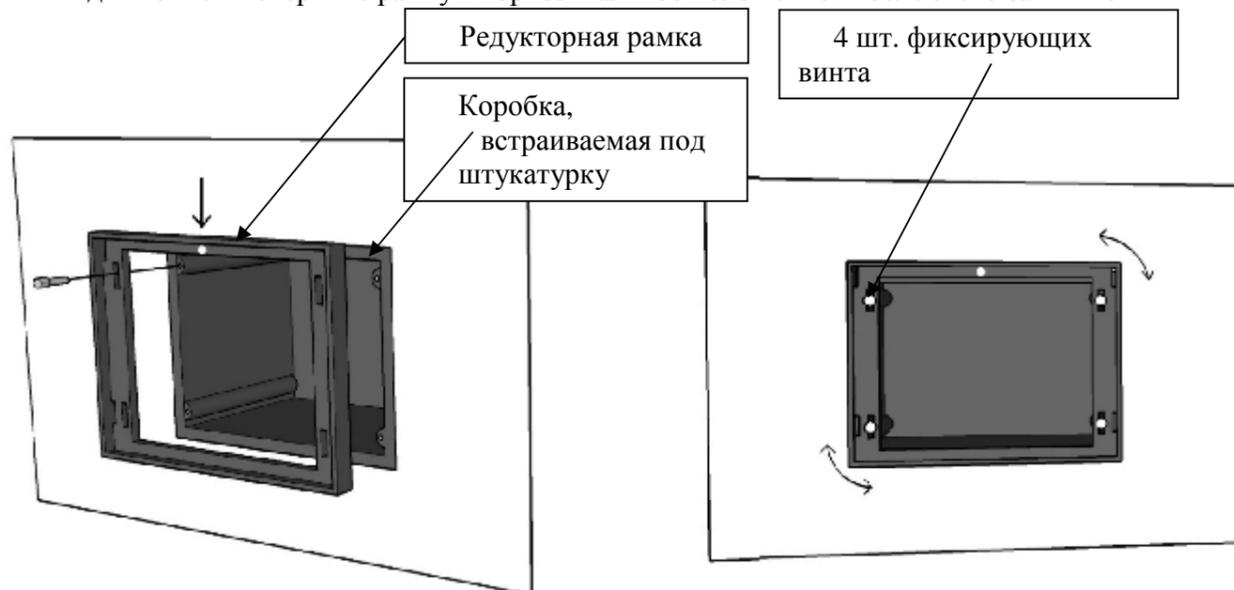
3. Перед установкой блока управления присоедините все кабели, включая кабель температурного датчика. Крючки блока управления с лицевой панелью вставьте до упора в отверстия на рамке и потяните вниз.
