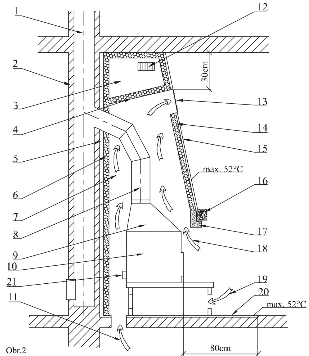
Schéma uspořádání krbové sestavy obecně platí také pro dvouplášťové krbové vložky a krbové vložky s teplo-akumulačním i teplovodním výměníkem.
